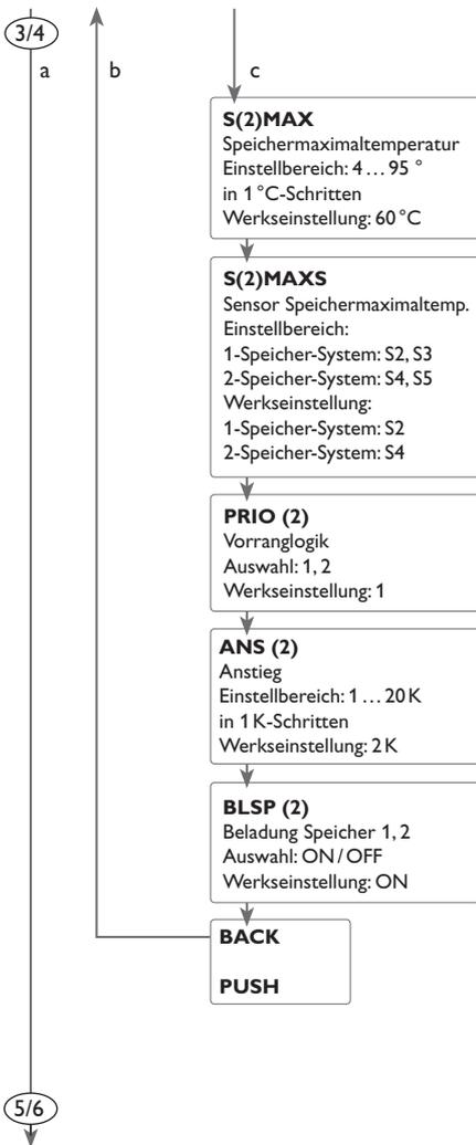
Die Vorranglogik findet nur in 2-Speicher-Systemen und Schichtenspeichern Anwendung und bestimmt die Aufteilung der Wärme zwischen den Speichern.
