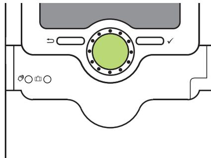
Der Regler wird über 2 Tasten und 1 Einstellrad (Lightwheel®) unterhalb des Displays bedient:
