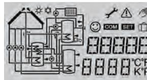
Das System-Monitoring-Display besteht aus 3 Bereichen: Der Kanalanzeige, der Symbolleiste und der Systemdarstellung.
