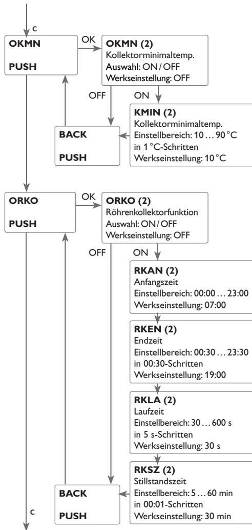
Die Kollektorminimaltemperatur dient dazu, eine Mindest-Einschalttemperatur vorzugeben, die überschritten werden muss, damit die Solarpumpe (R1 / R2) einschaltet. Wenn die Kollektortemperatur die eingestellte Minimaltemperatur unterschreitet, blinkt ☼ im Display.
