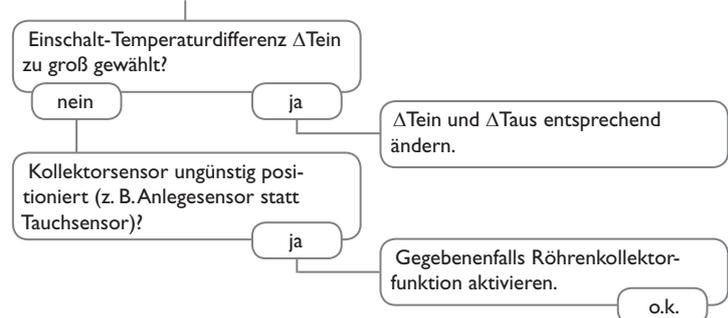
Pumpe läuft kurz an, schaltet ab, schaltet wieder an usw. („Reglerflattern“)
