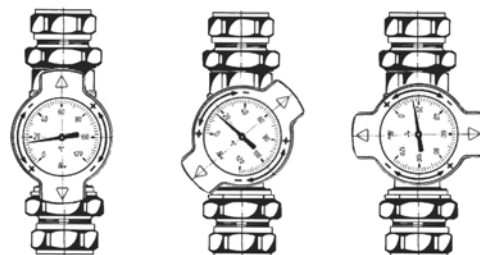
Schwerkraftbremse in Betrieb
